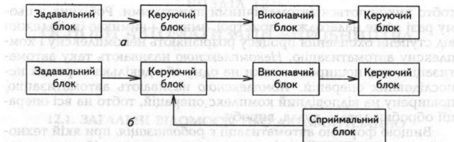
Рис. 171. Схеми автоматичної системи керування: а — з розімкнутим ланцюгом дії; б — із замкнутим ланцюгом дії.
